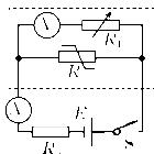
(2)由实验原理可知,电流表①和 $R_1$ 串联后与 $R$ 并联,根据欧姆定律得 $R=\frac{I_1(R_1+R_g)}{I-I_1}$ ,
