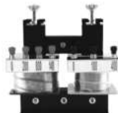
乙 组装后的变压器
