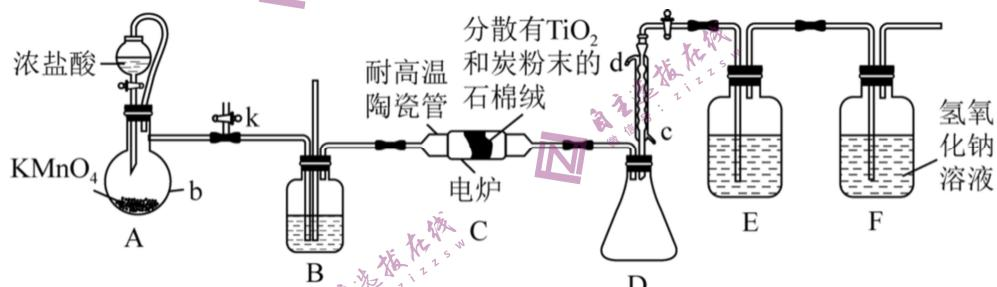
已知:  $\text{TiCl}_4$  易挥发, 高温时能与  $\text{O}_2$  反应, 不与  $\text{HCl}$  反应, 其他相关信息如下表所示:
