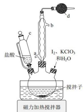
碘、2.60g 氯酸钾和 50mL 水，滴加 6 mol/L 盐酸至 pH=1，控制温度 85°C 左右，装置如图所示。
