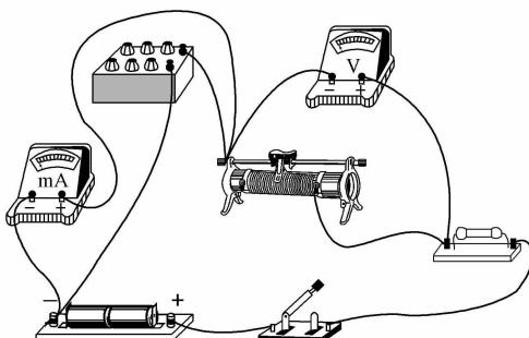
(3)由图丙可知,电流表示数的最大值为45mA,则电路中电流的最大值为450mA,两节干电池的电动势约为3V,则电路中总电阻为  $R=\frac{E}{I}=\frac{3}{0.45}\Omega=6.67\Omega$ ,所以滑动变阻器应选择E;为了保护电路,开关闭合前,应使滑动变阻器接入电路的电阻值最大,即滑动变阻器的滑动触头应位于最左端.
