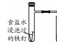
D. 证明铁钉发生吸氧腐蚀
