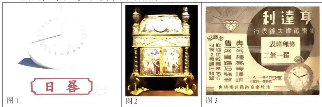
图1所示为日晷。日晷是利用太阳投射的影子来测定时刻的装置，采用干支计时，从上古沿用至
