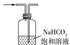
C. 除去 \text{SO}_2 中的 \text{HCl}
