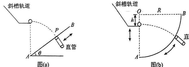
实验一: 如图(a)所示, 一倾斜角度为 $\theta$ 的斜面AB, A点为斜面最低点, 直管保持与斜面垂直, 管口与斜面在同一平面内, 平抛运动实验轨道抛出口位于A点正上方某处。为让小球能够落入直管, 可以根据需要沿斜面移动直管。
