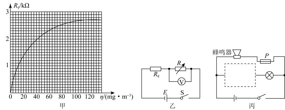
(1)该学习小组找来量程为0~3 V的理想电压表,并将表盘的0~1 V区域涂成红色,然后将气敏电阻 $R_q$ 、电源(电动势 $E=4\text{ V}$ ,内阻忽略)、电压表和调好阻值的电阻箱连接成如图乙所示的电路。将整个电路置于密闭容器中,充入一氧化碳气体,随着一氧化碳浓度的增加,电压表的读数逐渐\_\_\_\_\_。(填“增大”或“减小”),当浓度达到 $58\text{ mg/m}^3$ 时,电压表指针恰好指到表盘红色区的右边缘即1 V处,则他们调好的电阻箱的阻值是\_\_\_\_\_Ω(结果保留3位有效数字);若要使该装置在一氧化碳浓度更低时,指针就指到红色区,应将电阻箱的阻值适当\_\_\_\_\_。(填“调大”或“调小”)。
