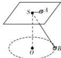
8. 如图所示，一不可伸缩、质量不计的细线跨过同一高度处的两个光滑轻质定滑轮连接着质量相同的物体 A 和 B，A 套在固定的光滑水平杆上，物体、细线、滑轮和杆都在同一竖直平面内，水平细线与杆的距离为  $h=0.2\text{m}$ 。当倾斜细线与杆的夹角  $\alpha=53^\circ$  时，同时无初速度释放 A 和 B。关于 A、B 此后的运动，下列判断正确的是 ( $\cos 53^\circ=0.6$ ,  $\sin 53^\circ=0.8$ , 重力加速度  $g$  取  $10\text{m/s}^2$ ) ( )
