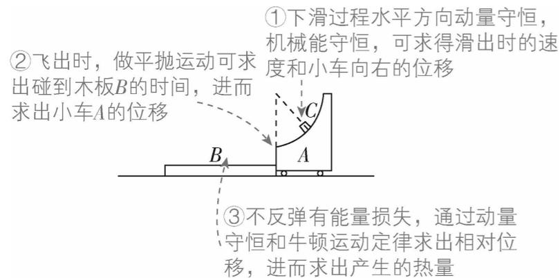
【详解】(1)滑块在小车上下滑过程，由于滑块和小车在水平方向不受外力作用，所以滑块和小车组成的系统在水平方向动量守恒，有  $0 = m_C v_C - m_A v_A$  (1分)
