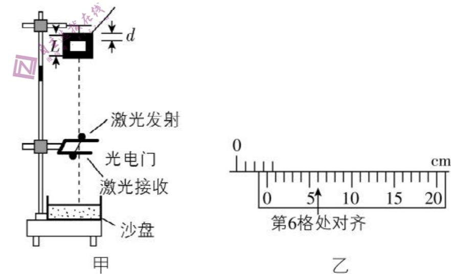
(1)如图乙, 用游标卡尺测得“回”字形铁片遮光宽度  $d = 3.30 \text{ mm}$ , 该读数是游标尺中第 6 格刻度线与主尺第 \_\_\_\_\_ mm 刻度线对齐得到的。
