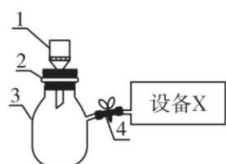
1—布氏漏斗(可承受加大压强) 2—橡皮塞(起到密封效果) 3—吸滤瓶(玻璃材质) 4—橡皮管(带阀门)
