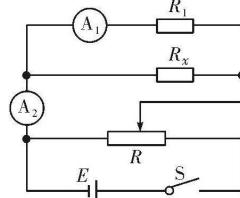
定值电阻应选择  $R_1$ , 电流表  $A_2$  内阻未知, 所以应用外接法, 即如图所示电路, 此接法两表恰好几乎同时满偏。
