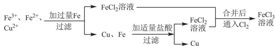
(1) 由工艺流程可知, 滤渣③中含有金属铜, 目的是制取氯化铁, 废液应该与过量的 Fe 反应, 故①为 Fe; 滤液②中含有  $\text{FeCl}_2$ , ⑤ $\text{Cl}_2$  可以得到氯化铁; 滤渣③中含有金属 Cu、未反应的 Fe, 加入④盐酸, 过滤, 回收铜, 滤液⑤中含有  $\text{FeCl}_2$ , 与滤液②合并, 制备氯化铁; 由上述分析可知: ①Fe、② $\text{FeCl}_2$ 、③Fe 和 Cu、④HCl、⑤ $\text{Cl}_2$ , 故答案为: Fe;  $\text{FeCl}_2$ ; Fe 和 Cu; HCl;  $\text{Cl}_2$ ;
