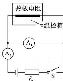
解析: (1) 电流表  $A_1$  的内阻已知, 可当成电压表使用, 电流表  $A_2$  测干路电流, 电路设计如图所示.
