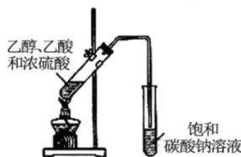
C. 制取乙酸乙酯(必要时可加沸石)
