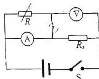
(1) 为了较准确地测量电阻  $R_x$ ，电压表应选 \_\_\_\_\_（选填“A”或“B”），电流表应选 \_\_\_\_\_（选填“C”或“D”）。
