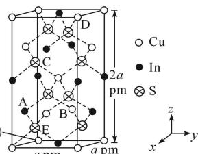
$= 1:1:2$ , 相当于该晶胞中含有 4 个  $\text{CuInS}_2$ , 晶胞体积  $= (a \times 10^{-10} \times a \times 10^{-10} \times 2a \times 10^{-10}) \text{ cm}^3 = 2a^3$
