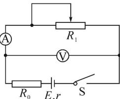
(2) 由于此锂电池的内阻比较小，若用原电路测量，则改变滑动变阻器接入电路的阻值时，内阻分压小，导致外电路电压表示数变化不明显，不利于测量，误差较大；新的电路设计，仍然需要选用定值电阻一方面起到保护电路的作用；另一方面，将定值电阻与电源先串联，并将电流表外接，则在改变滑动变阻器接入电路的阻值时，电压表、电流表的示数变化较为明显，测量误差也较小，得出的结果更为精确，如上图所示；
