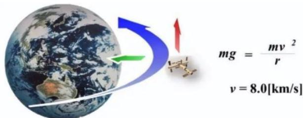
如上图所示，航天器在做近 8 千米/秒的高速运动，按照牛顿第一定律，航天器应该是保持远离地球的匀速直线运动，而由于地球引力的作用，使航天器绕着地球做圆周运动，航天器所受的重力提供了航天器绕地球做圆周运动所需的向心力。这两个力基本相等，使得在航天器上感受到的只有残余的重力，称为微重力。
