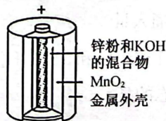
碱性锌锰电池的构造
